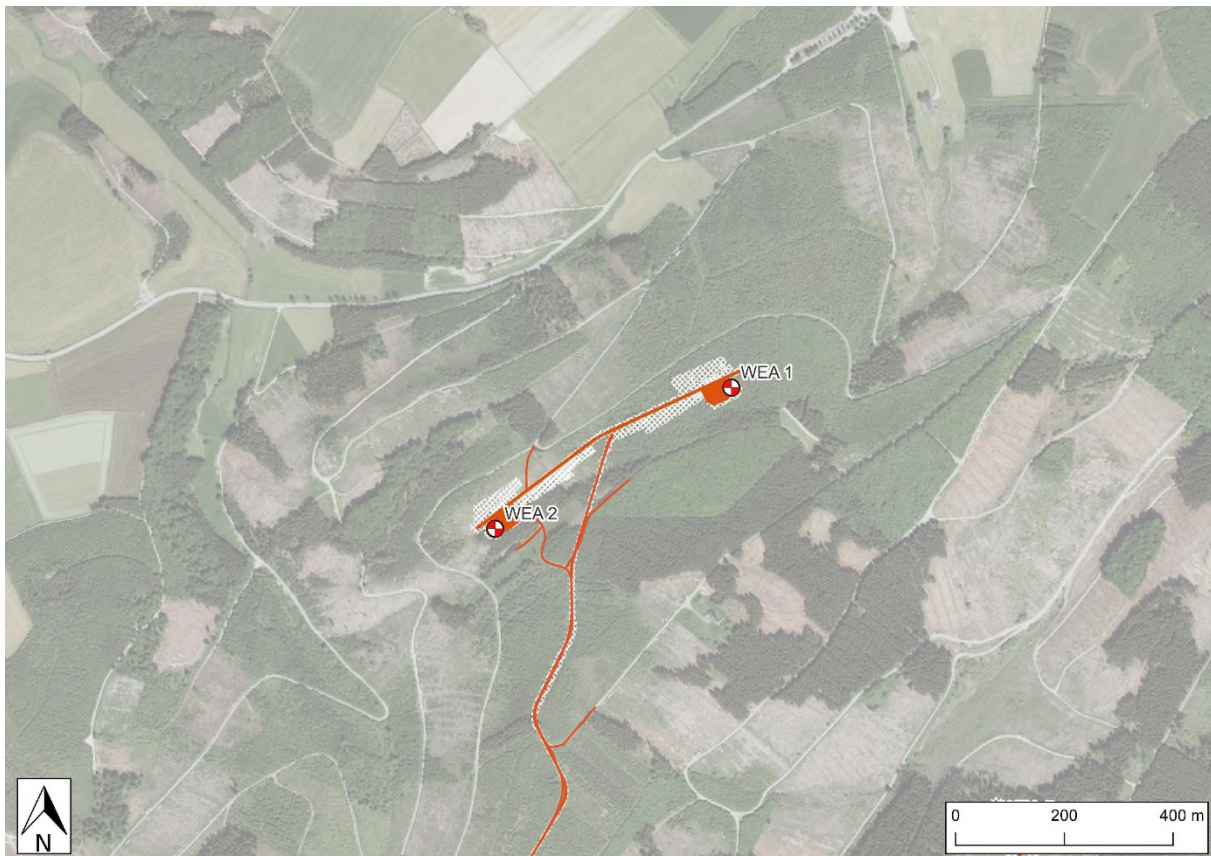
Abbildung 4: Darstellung der dauerhaften Eingriffsbereiche (Kranstellflächen, Zuwegung; rot), der temporären Eingriffsbereiche (Böschungsbereiche, Montageflächen, Kranstellflächen, Kranausleger; weiß kariert) und der geplanten WEA (rot/weiß) im nördlichen UG Esloher Höhe. Quelle: Digitale Orthophotos NRW (DOP) © GEOBASIS NRW 2023a
